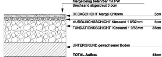
Einfache und schnelle Bauweise, gelegentlicher Unterhalt, Kosten ca. 35.-/m2
